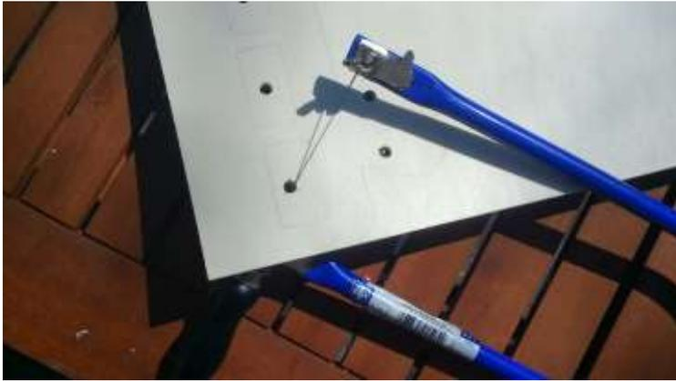
Das Sägeblatt der Bügelsäge durch die Löcher der Fenster führen und die Fenster aussägen. Dafür einfach die Flügelschraube lösen, das Sägeblatt durch das Loch führen und wieder einspannen.
